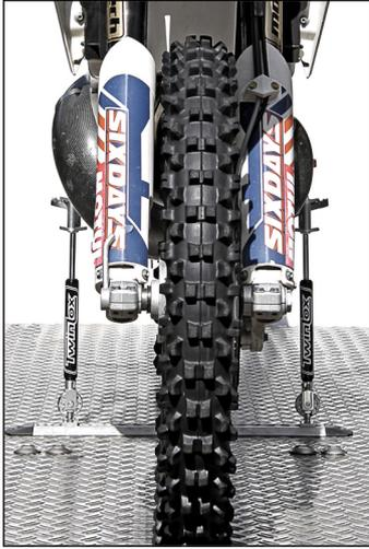
**1** Zurrpunkte (c) mittig unterhalb der Fußrasten so montieren, dass Twinlox möglichst senkrecht steht.
