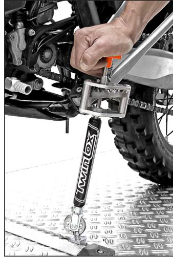
**3** Zum Spannen den farbigen Buzzer nach unten drücken und gleichzeitig das Motorrad zur Seite neigen.
