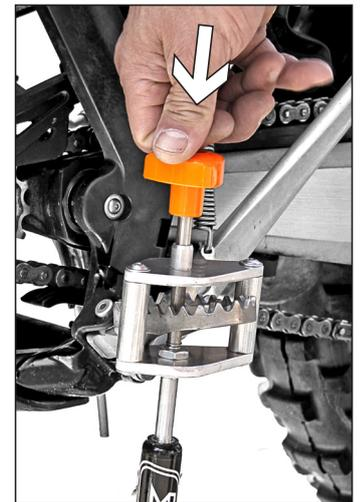
**7** Zum Entspannen des Motorrads Buzzer gedrückt halten und Motorrad in die Ausgangslage zurückführen.
