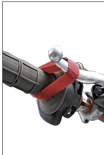
**6** Abschließend Vorderradbremse am Lenker mit Klettband (b) feststellen.
